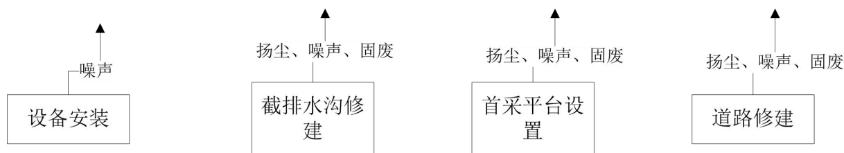
图 4.1-1 项目施工工艺流程及主要产污环节图
