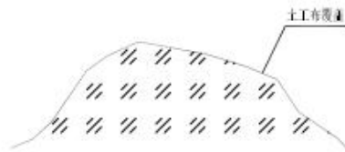
临时堆土土工布覆盖示意图
