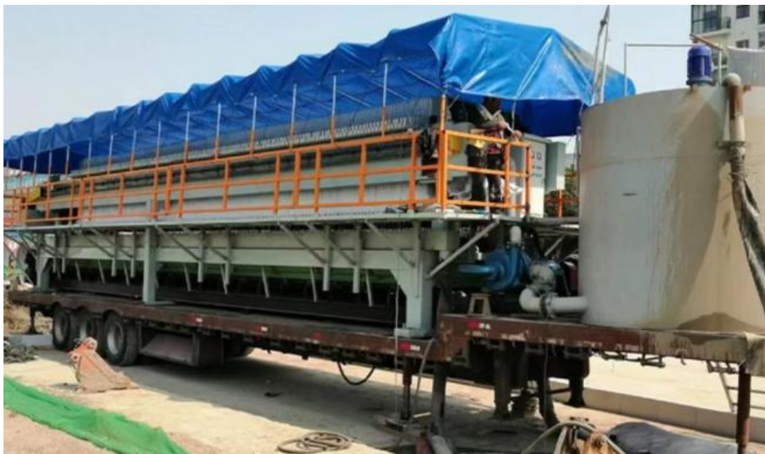
图 3.1.5-29 移动式淤泥固化车
