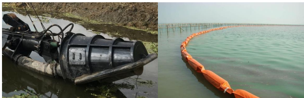
图 3.1.5-5 封闭式环保绞吸罩细节（左）、防污幕帘（右）
