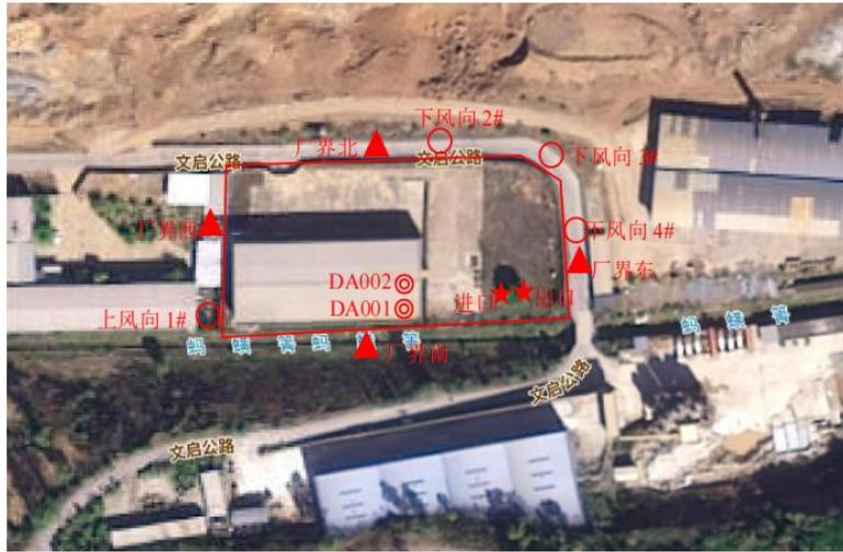
备注：▲为噪声检测点位，◎为固定源废气检测点位，★为废水采样点位，○为无组织检测点位。
